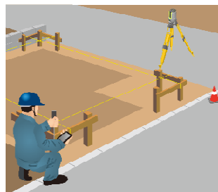
丁張りの設置
